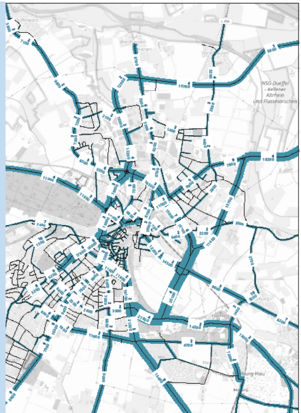
Abbildung 21: Kfz-Belastungen/Prognose 2030 einschl. B 220n, ohne B 9n
